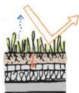
Schéma 11 La végétalisation de la toiture permet de profiter des effets climatiques des sols naturels. Leur efficacité dépend de la disponibilité en eau. (Source: ADEME)
